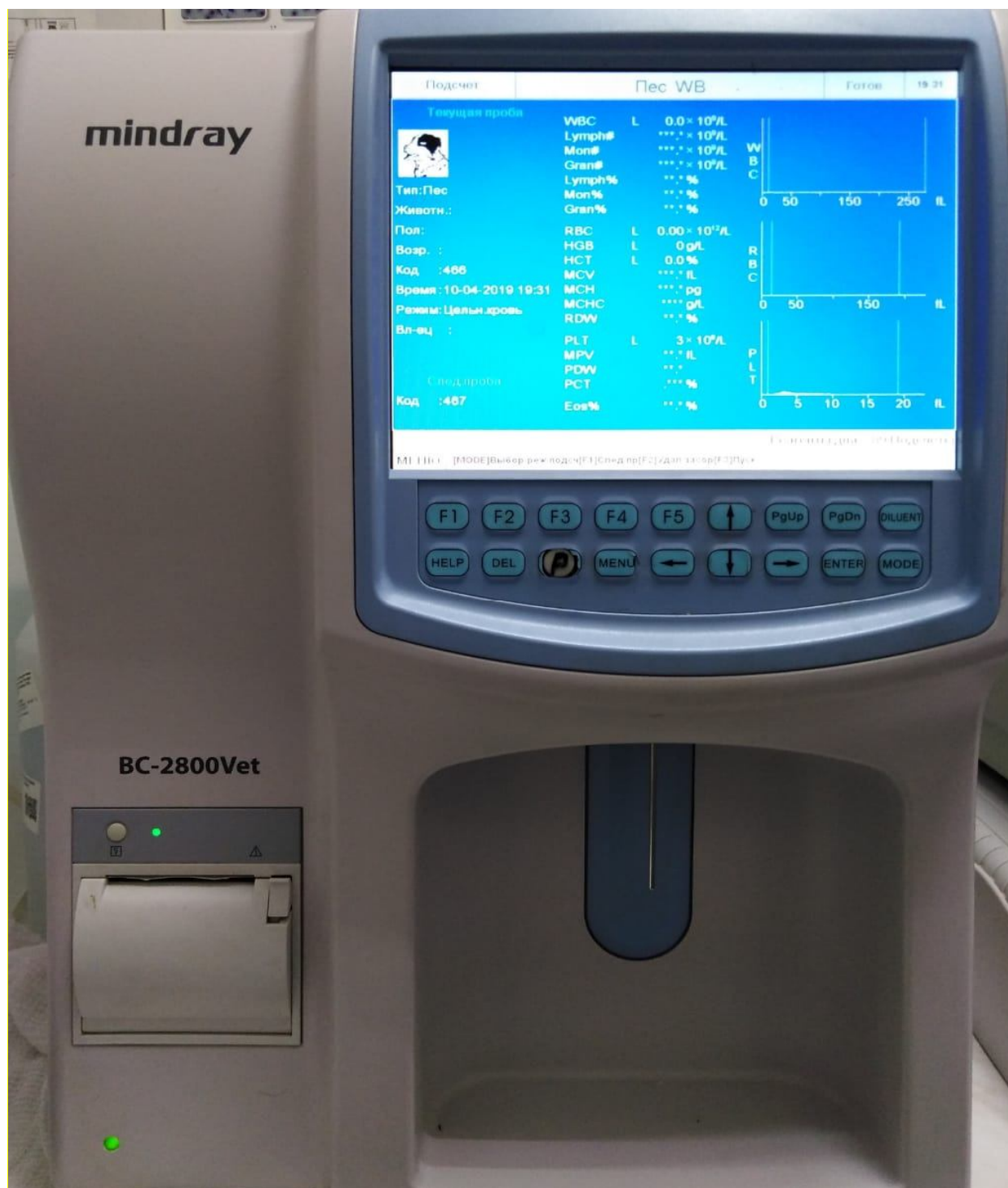
Рисунок 8. Автоматический гематологический анализатор крови Mindrey BC-2800 vet (Китай) с импедансным способом регистрации частиц
